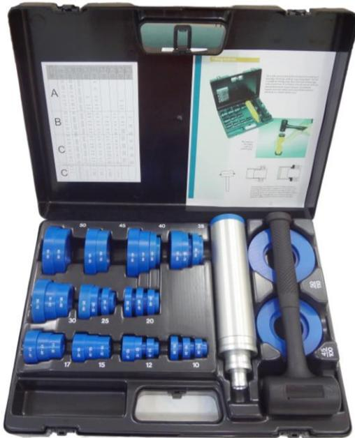
Utilice la herramienta FT-33 para un montaje seguro, preciso y rápido de rodamientos, casquillos, sellos y poleas. Con este kit puede montar más de 230 tamaños de rodamientos con un diámetro de 10 a 50 mm. Incluye tres mangos de alto impacto de aluminio especial, 33 piezas resistentes al impacto y un martillo de goma anti rebote, todo en un estuche de plástico robusto.
