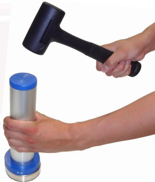
Para los rodamientos, es importante que los anillos se apoyen en el interior y exterior del rodamiento para evitar daños innecesarios. El uso de un martillo anti rebote de alto impacto evita así el contacto metal-metal. De esta manera la fuerza del golpe con el que se monta no se transmite a través de los elementos rodantes.
